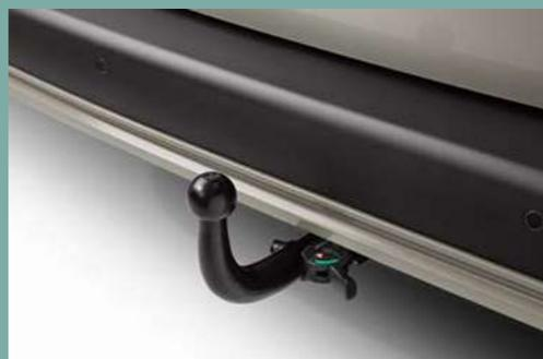
ANHÄNGEVORRICHTUNG OHNE WERKZEUG ABNEHMBAR
