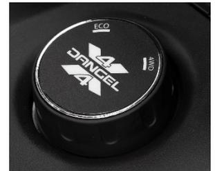
**ECO 2WD Modus:** der 4x4 Antriebsstrang wird dank einer Klauenkupplung im vorderen Verteilergetriebe ausgekuppelt.
